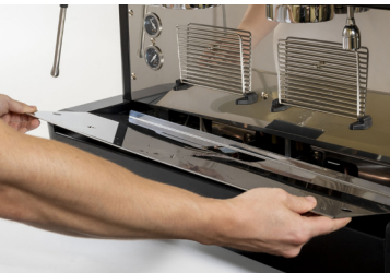
2) Retirar a grelha de proteção inferior de forma a expor o tubo de esgoto.
