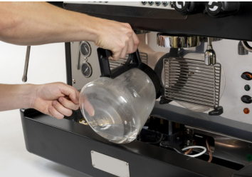
4) Depositar a água do recipiente na caixa de drenagem e repetir pelo menos 2 vezes.
