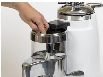
7) Utilizar um pincel para limpar o café moído. Pressionar a alavanca para rodar a estrela e continuar o procedimento até a estrela ter voltado à posição inicial.
